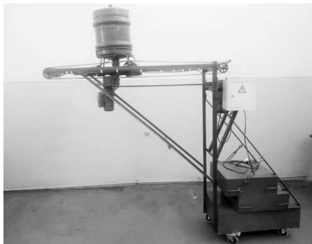
Расм.1. Балиқларни дискли озиклантириш қурилмасининг умумий кўриниши.
