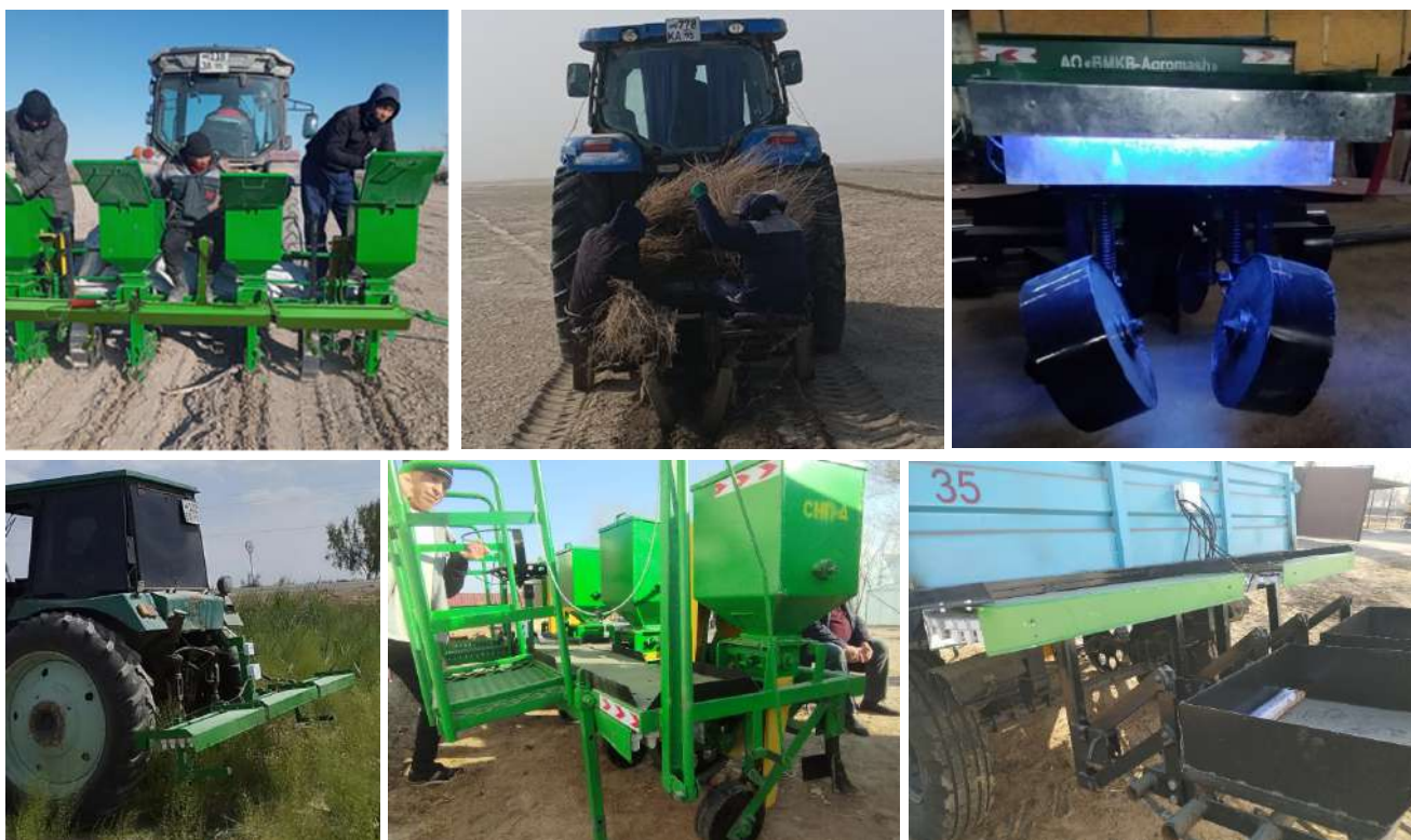
Рис. 4. Машины комплекса специализированной техники, агрегируемые с установкой УФО для проведения облучения посевных семян и посадочного материала при выполнении агротехнических операций с одновременным облучением почвенного покрова ультрафиолетовыми лучами за один проход.
